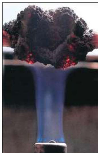
Corretta espansione del prodotto installato in ambiente asciutto Correct expansion of the product installed in a dry environment
