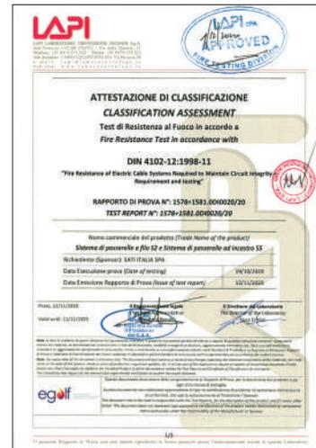
Determinazione della resistenza al fuoco di un sistema di passerelle metalliche contenenti cavi elettrici che richiedono il mantenimento dell'integrità del circuito durante il periodo di prova, secondo DIN 4102-12:1998-11: "Fire Resistance of Electric Cable Systems Required to Maintain Circuit Integrity – Requirement and testing".
