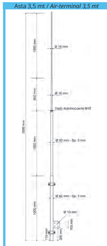
Asta 3,5 mt / Air-terminal 3,5 mt
