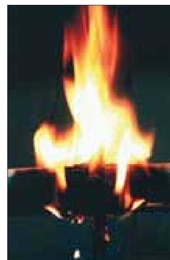
Mancata espansione del prodotto installato in ambiente umido
